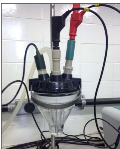
Figura 19: Célula eletroquímica utilizada nas medidas voltamétricas, com os respectivos eletrodos referência, auxiliar e trabalho, imersos na solução contendo o eletrólito suporte.
