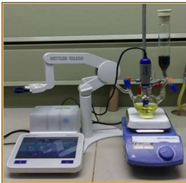
Figura 20: Foto da sonda medidora de oxigênio utilizada nas reações de oxidação química da água.
