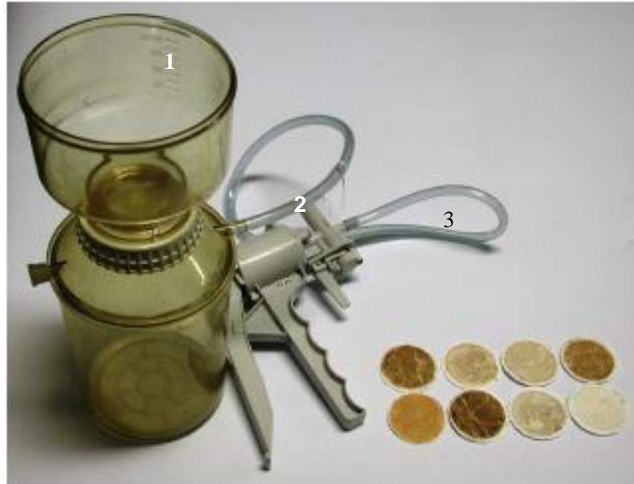
Figura 22: Material de filtração formado pelo suporte (1) e bomba de sucção (2) junto com os filtros de sílica (3).
