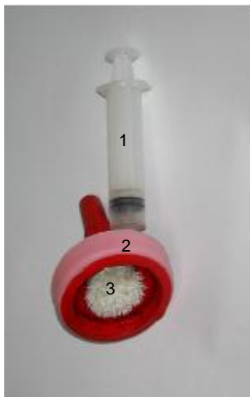
Figura 23: Amostrador de Perifíton adaptado pelo LERC constituído de seringa (1), desentupidor (2) e escova (3)
