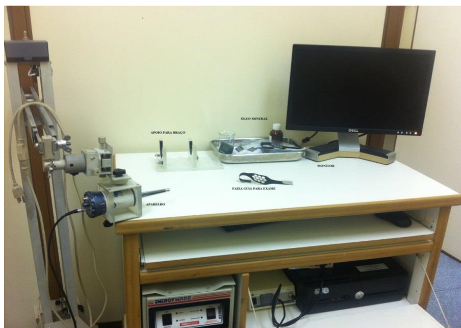
Figura 9 - Aparelho SDF- Microscan e seus componentes.
