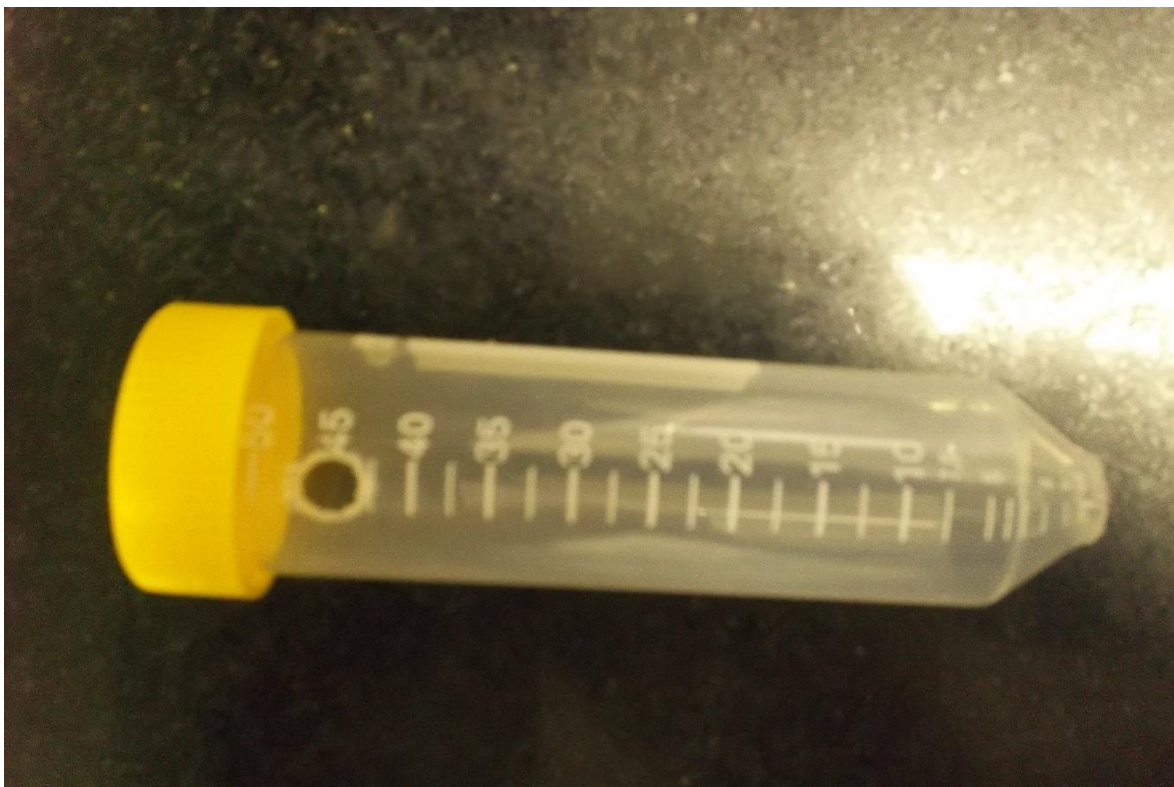
Figura 1 - Fotografia do tubo Falcon adaptado para a exposição ao estresse por contenção
