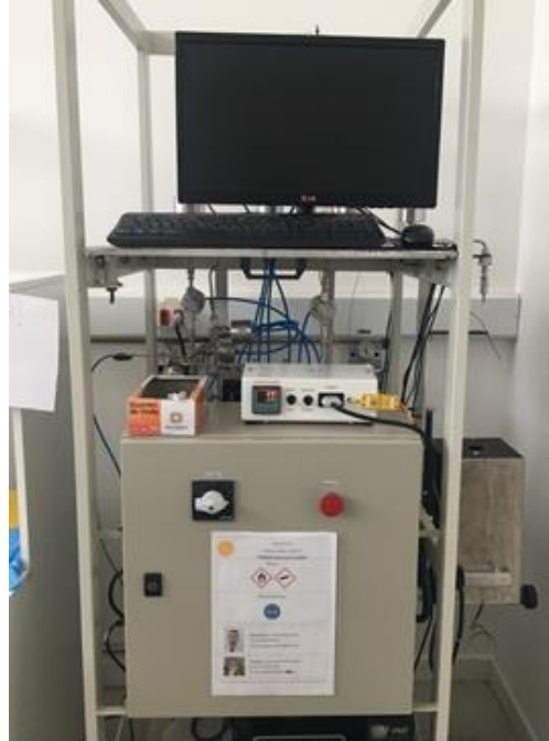
Figura 16 – Equipamento PCT Sieverts desenvolvido no LHM / UFSCar
