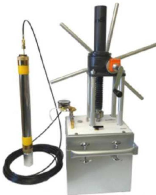
Figura 5 - Componentes do pressiômetro tipo *Texam* (cortesia *Roctest*).
