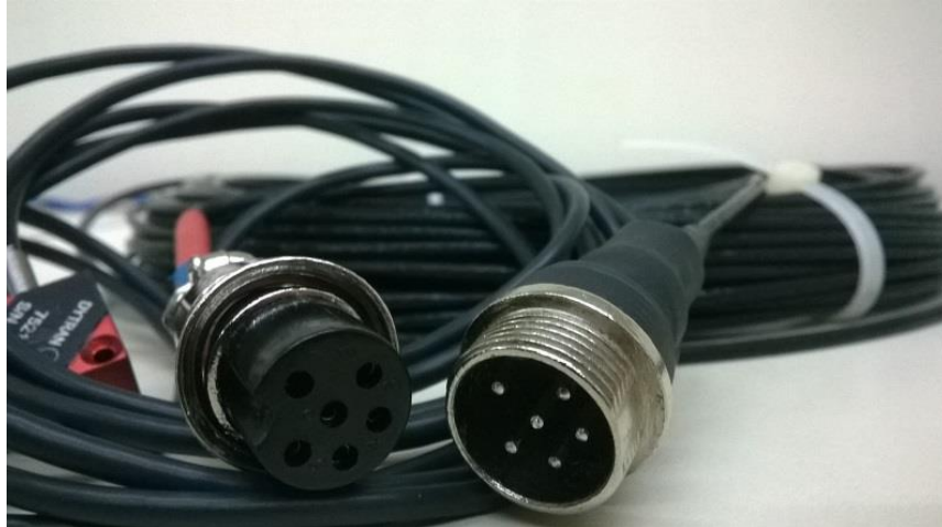
Figura 31 – Acelerômetro Dytran. Conector fêmea (esq.) / Conector macho (dir.).
