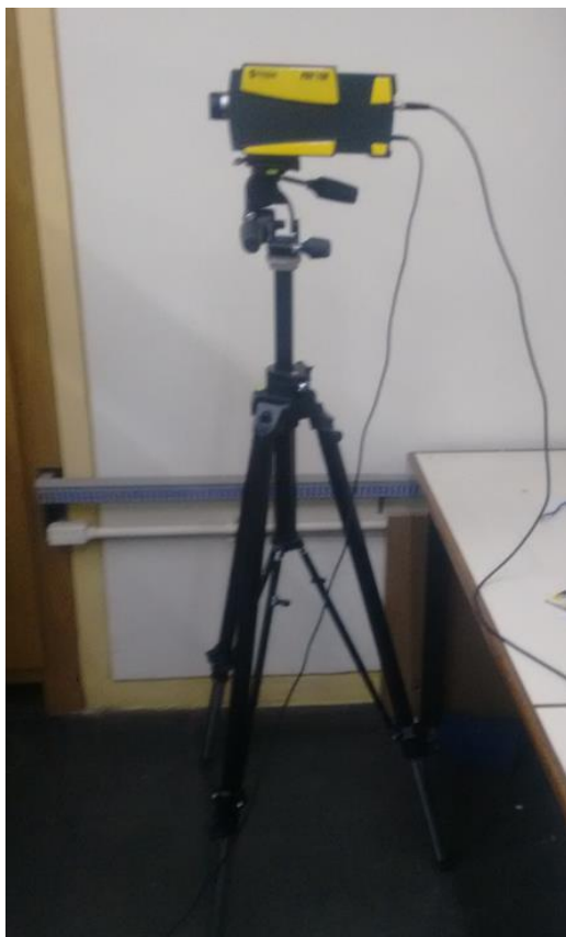
a) Detalhe do PDV 100 sobre o tripé
