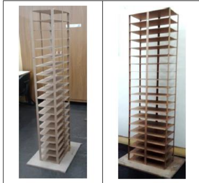
Figura 12 – Modelo do edifício em HDF, BASTOS et al. (2018).
