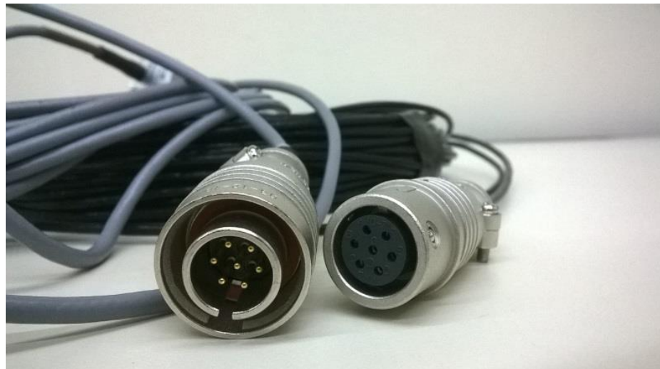
Figura 33 – Acelerômetro Kyowa. Conector macho (esq.) / Conector fêmea (dir.).
