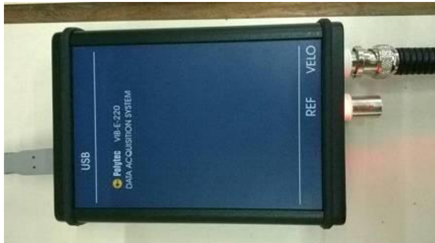
Figura 44 – PDV 100. Sistema de aquisição de dados (USB).
