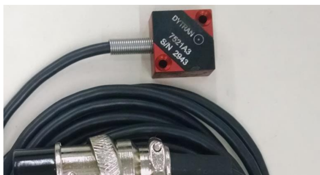
Figura 30 – Acelerômetro Dytran (transdutor de aceleração capacitivo).
