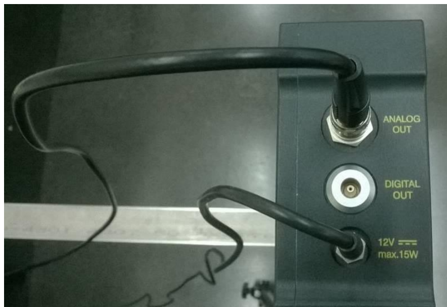
Figura 45 – PDV 100. Conexões de saída e alimentação.
