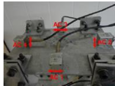
b) Acelerômetros na cobertura
