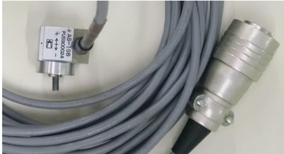
Figura 32 – Acelerômetro Kyowa (transdutor de aceleração resistivo).
