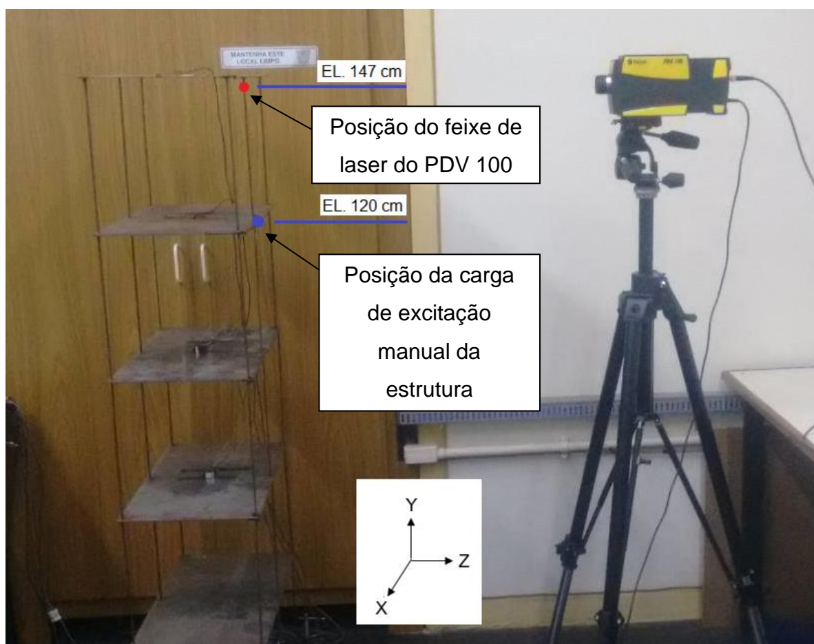
Figura 122 – Posição do feixe de laser e posição do ponto de excitação (eixo Z)
