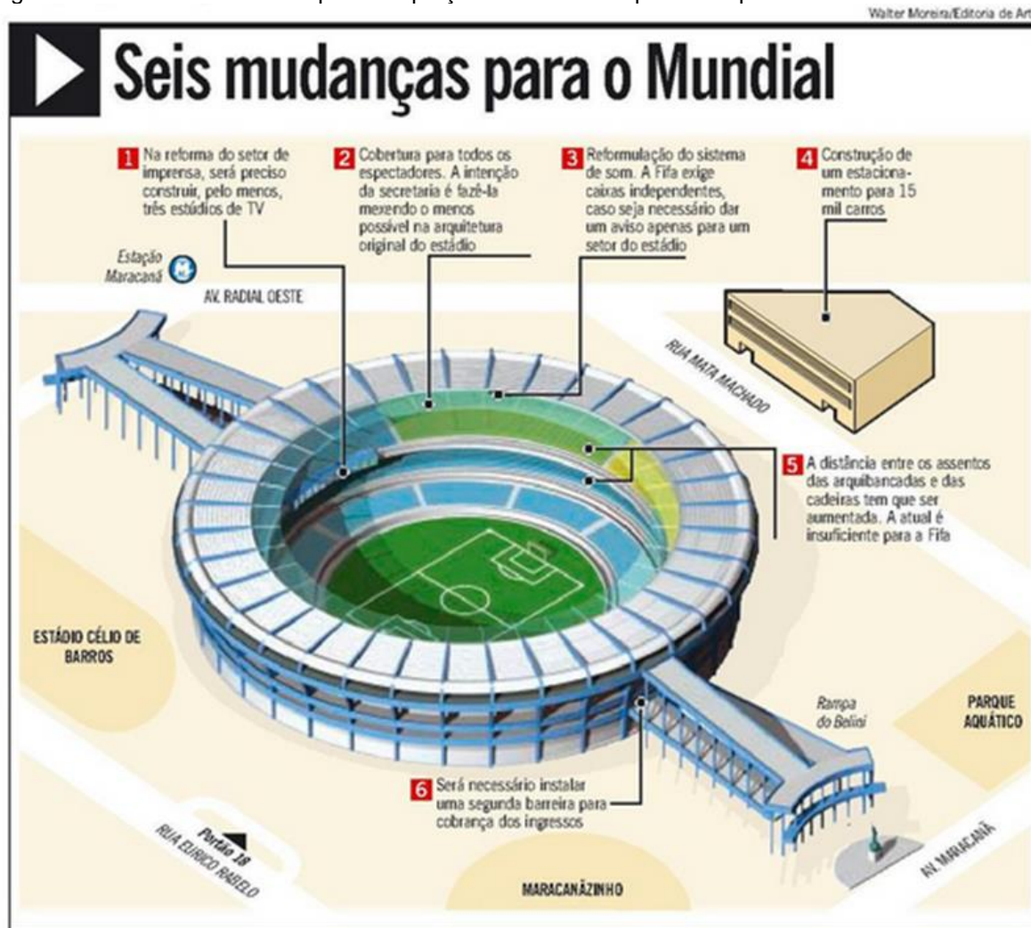
Figura 13 - Indicativo de obras para adaptação do Maracanã para a Copa de 2014
