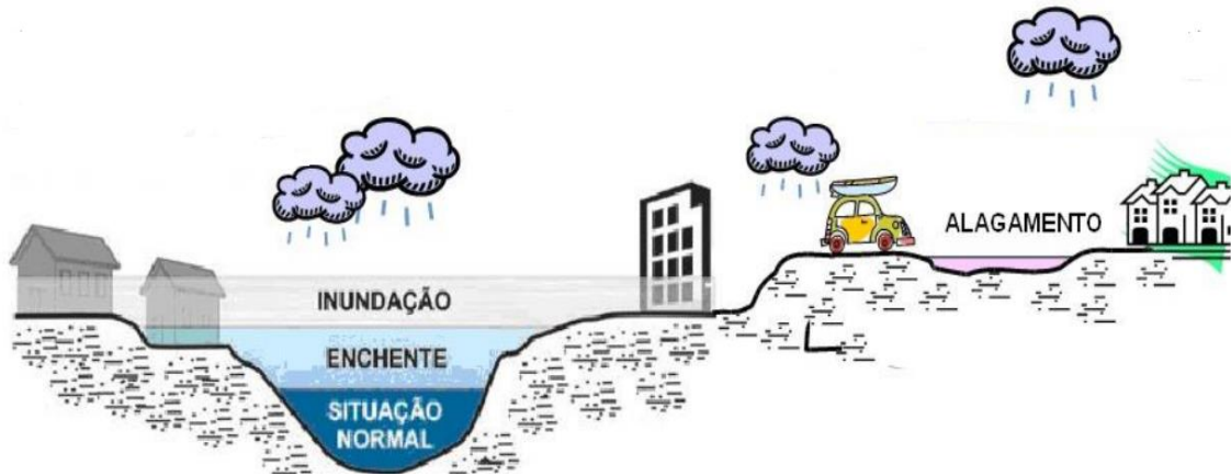
Figura 1 – Modelo do perfil esquemático do processo de enchente, inundação e alagamento
