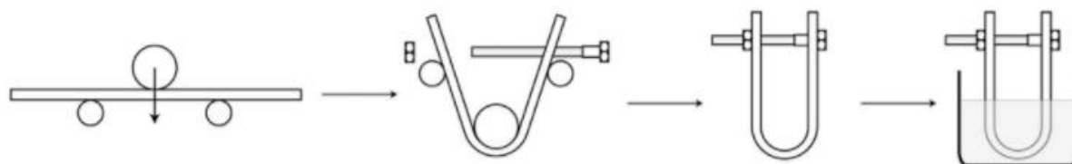
Figura 12 – Etapas do dobramento e fragilização por hidrogênio.
