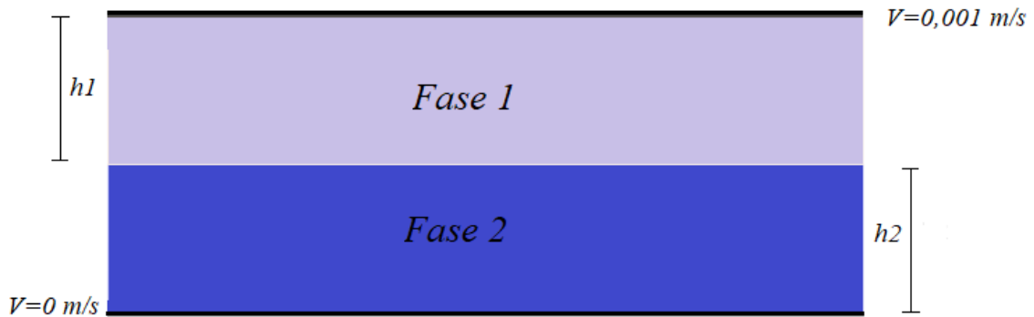
Figura 7 - Configuração geométrica para o escoamento de Couette
