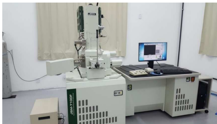
Figura 12 - MEV-FEG JSM-7100F (JEOL), laboratório Nanofab, departamento de engenharia mecânica, UERJ.
