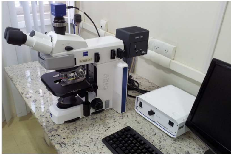
Figura 11 - Microscópio óptico do fabricante Zeiss, modelo Axio Scope A1, laboratório Van der Graff, PUC-Rio.
