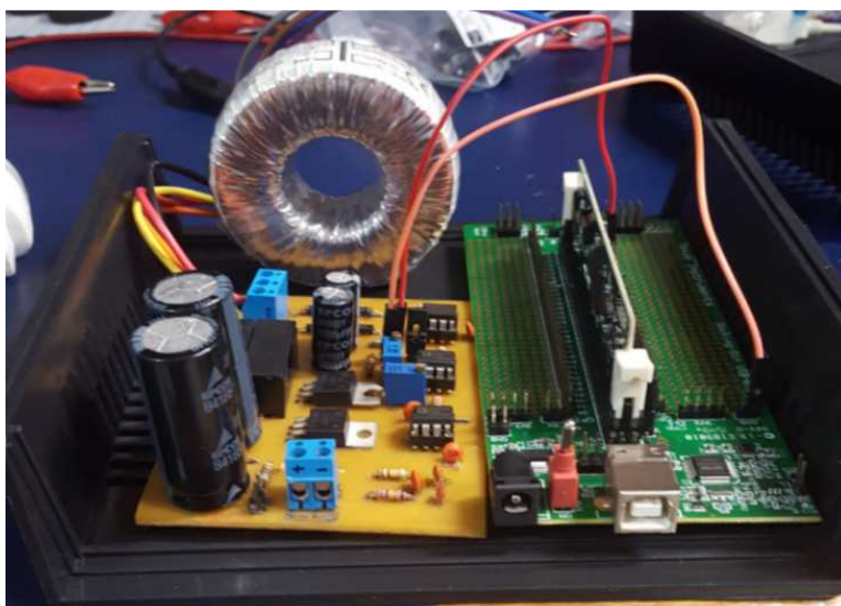
Figura 17 - Circuito analógico (amarelo) e Placa DSP (verde).
