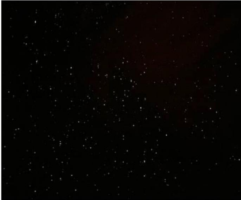
Figura 8 - Microporos em uma folha de alumínio visualizada em uma mesa de porosidade
