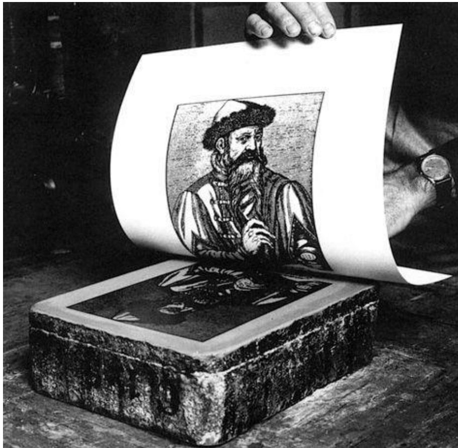
Figura 2 – Processo de impressão litográfica.
