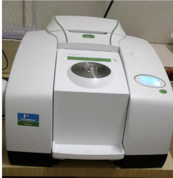
Figura 10 - Espectrofotômetro de infravermelho com acessório NIRA.
