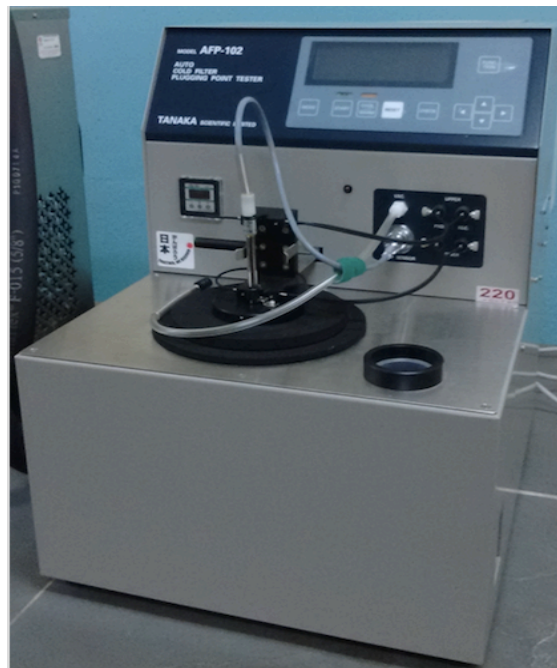
Figura 7 - Equipamento para ensaio do ponto de entupimento de filtro a frio, marca TANAKA modelo AFP-102.
