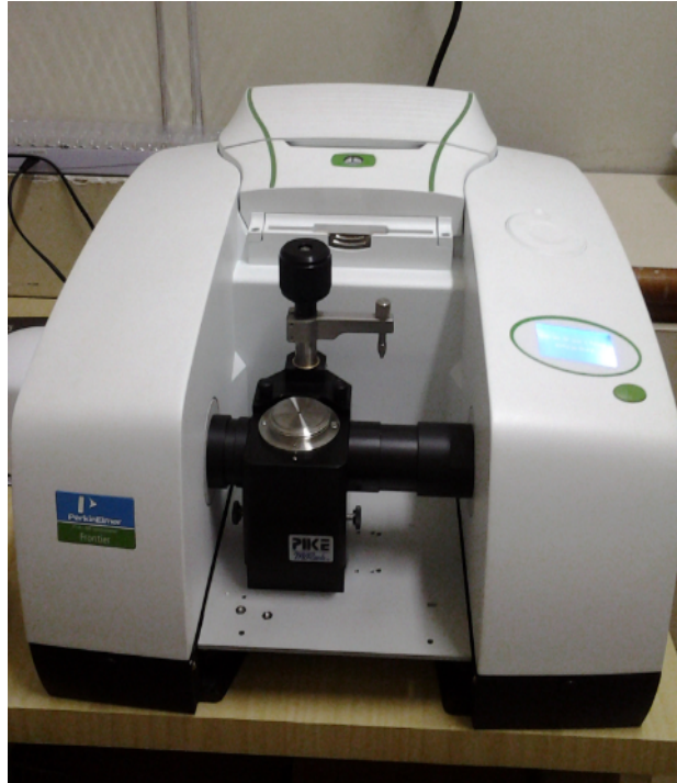
Figura 9 - Espectrofotômetro de infravermelho com acessório ATR.
