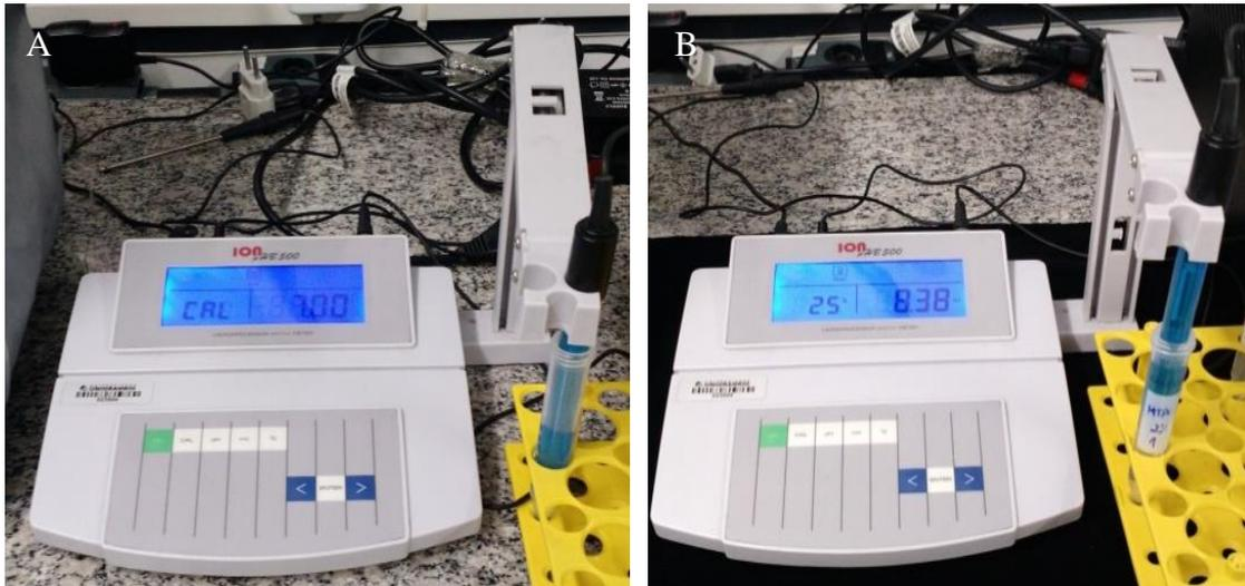
Legenda: (A) - Calibração do equipamento prévia ao início das análises com solução de pH pré-estabelecido em 7,00; (B) - Aferição do pH da amostra de cimento MTA Fillapex com incorporação de 2 % de NPs CHX-HMP.
