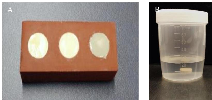
Legenda: (A) - Molde de borracha utilizado para obtenção dos discos dos demais cimentos endodônticos; (B) - Amostra imersa e suspensa em 20 mL de água destilada para avaliação da solubilidade.
