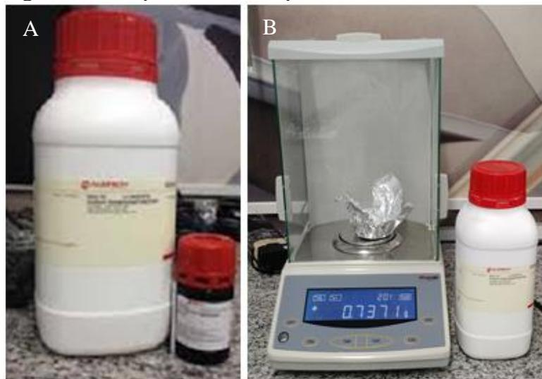
Legenda: (A) - Apresentação dos componentes utilizados na elaboração da suspensão: hexametáfosfato de sódio e digluconato de clorexidina; (B) - Pesagem do hexametáfosfato de sódio em balança analítica.
