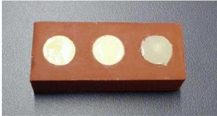
Legenda: Molde de borracha de 10 x 2 mm preenchido respectivamente com os cimentos: AH Plus, MTA Fillapex, PCS.
