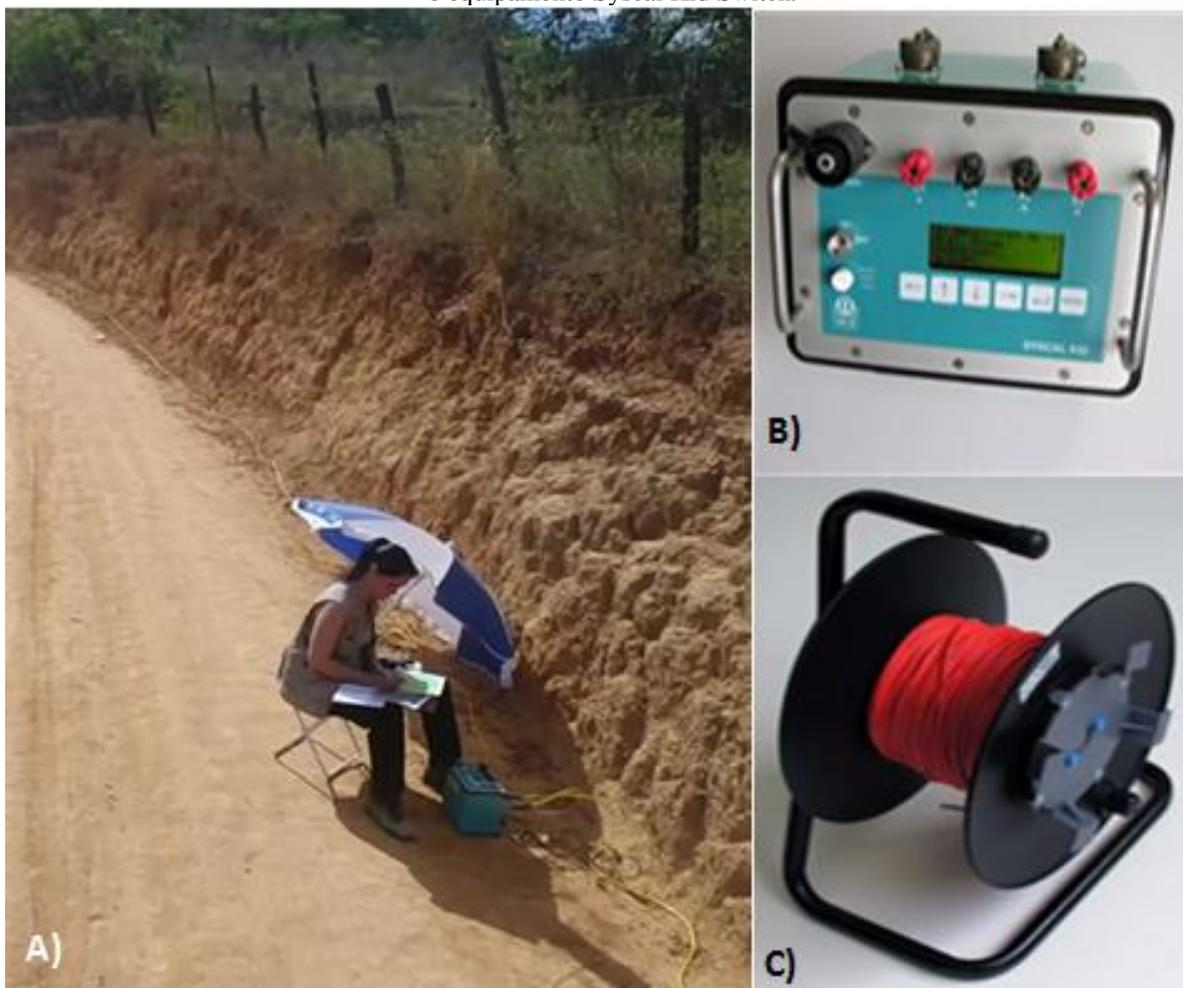
Legenda: A) Equipamento *Syscal Kid* em aquisição pelo método elétrico, por meio da técnica do caminhamento elétrico. B) Detalhe do módulo de aquisição do eletrorresistivímetro *Syscal Kid*. C) Cabo de conexão entre o módulo e os eletrodos para a injeção de corrente em subsuperfície.
