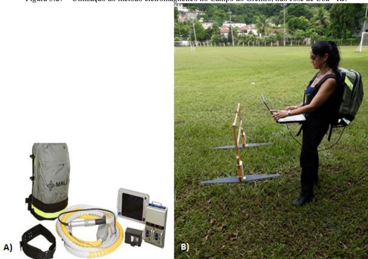
Legenda: Uso da técnica Ground Penetrating Radar (GPR) com o equipamento Mala, modelo ProEx, com as antenas de 50 MHz (A) e 100 MHz (B).
