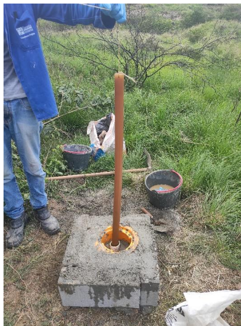
Figura 13 - Procedimento de retirada de água do poço de monitoramento com auxílio de uma bailer.
