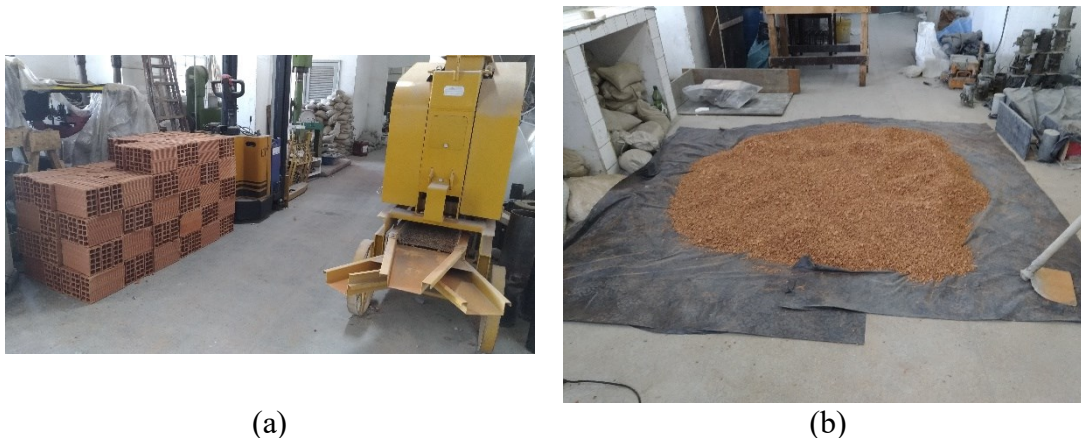
Figura 12 – Agregado graúdo de reciclado de tijolo, (a) produção e (b) execução da mistura do agregado de RMA na curva granulométrica.
