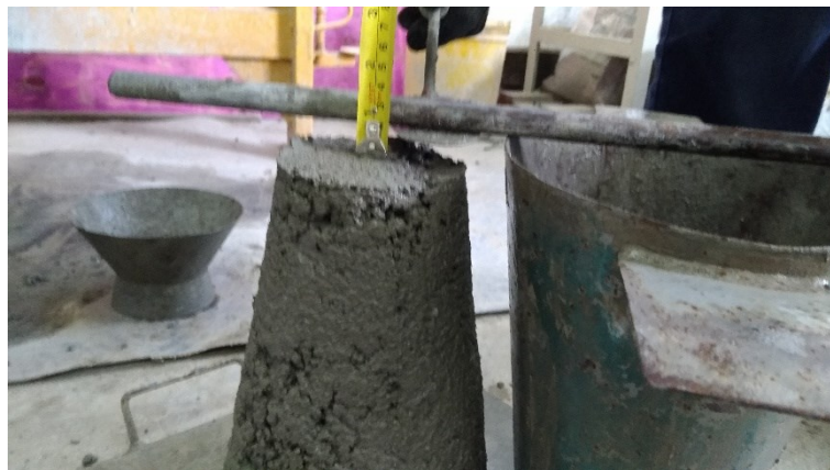
Figura 13 - Teste de abatimento " slump test "
