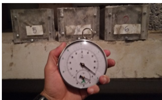
Figura 19 – Corpos de prova de retração por secagem armazenados na câmara úmida com temperatura e umidade relativa controladas.
