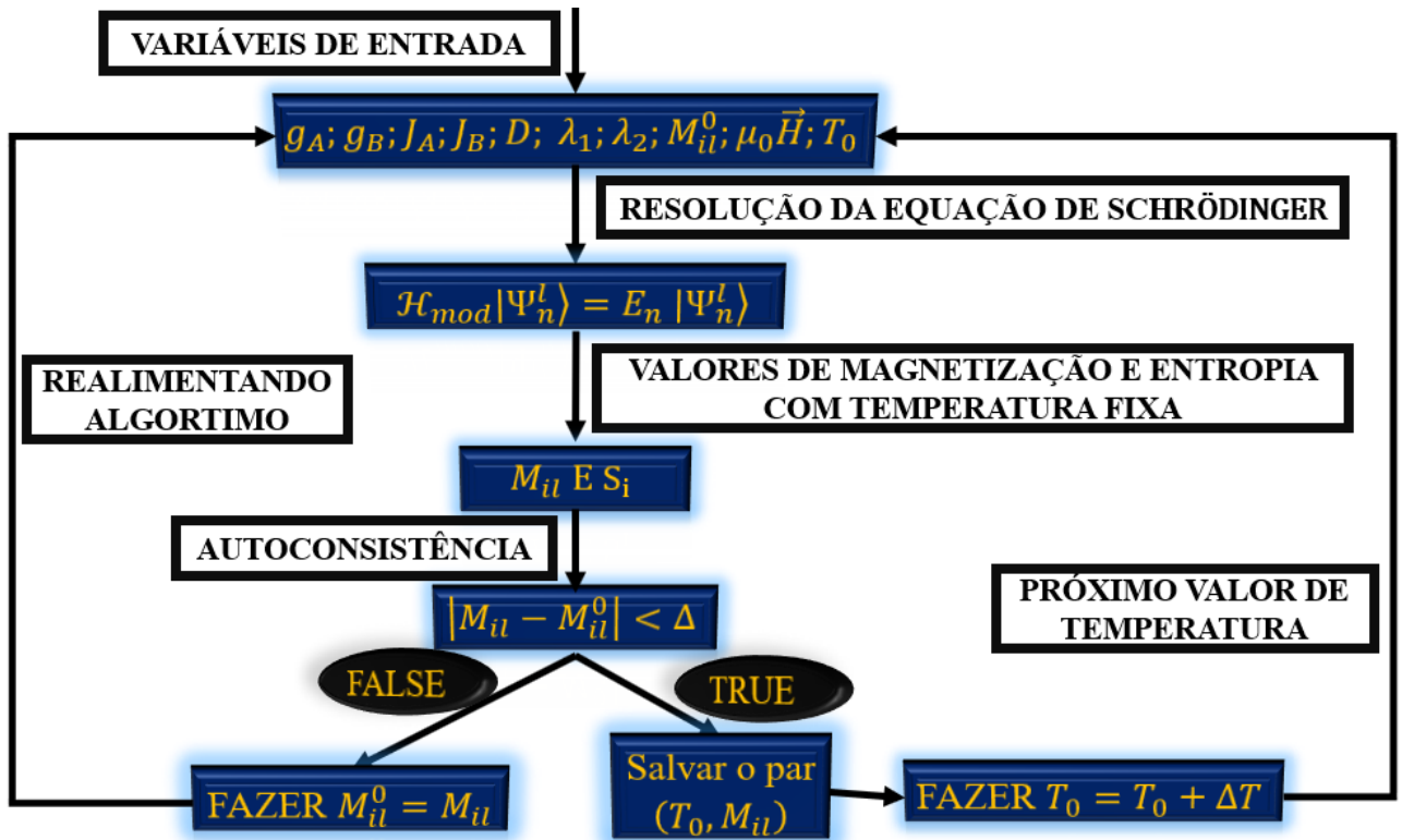
Figura 17 - Algoritmo do modelo anisotrópico
