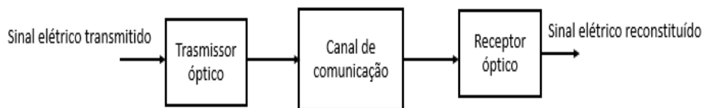
Figura 1 - Esquema básico de um sistema de comunicação óptico.
