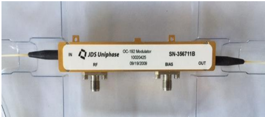
Figura 19 - Modulador Eletroóptico utilizado para calibração do interferômetro Mach-Zehnder.
