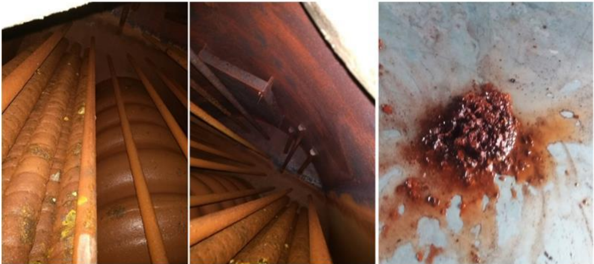
Figura 10 – Exame interno e amostra de material retirada.
