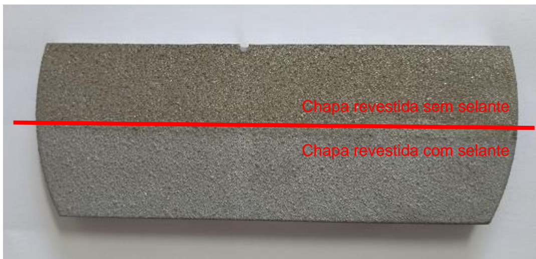
Figura 13 - Chapa de aço revestida com o selante aplicado.
