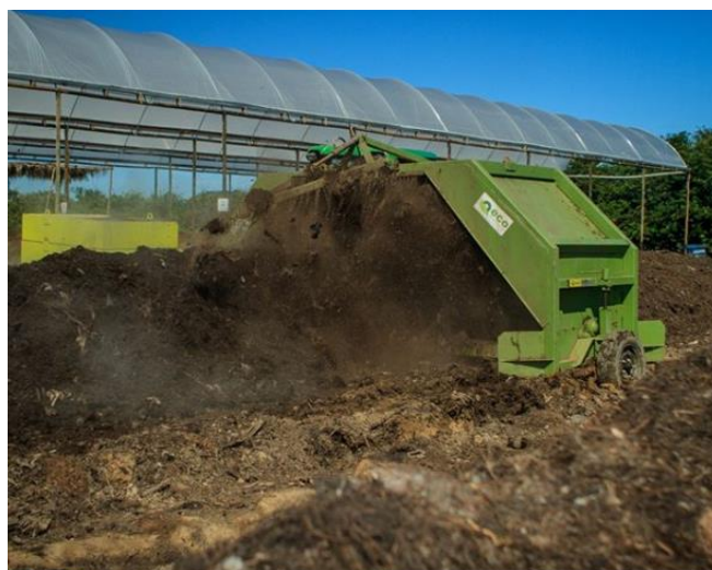
Figura 13 - Revolvedor mecânico em operação na empresa de compostagem.
