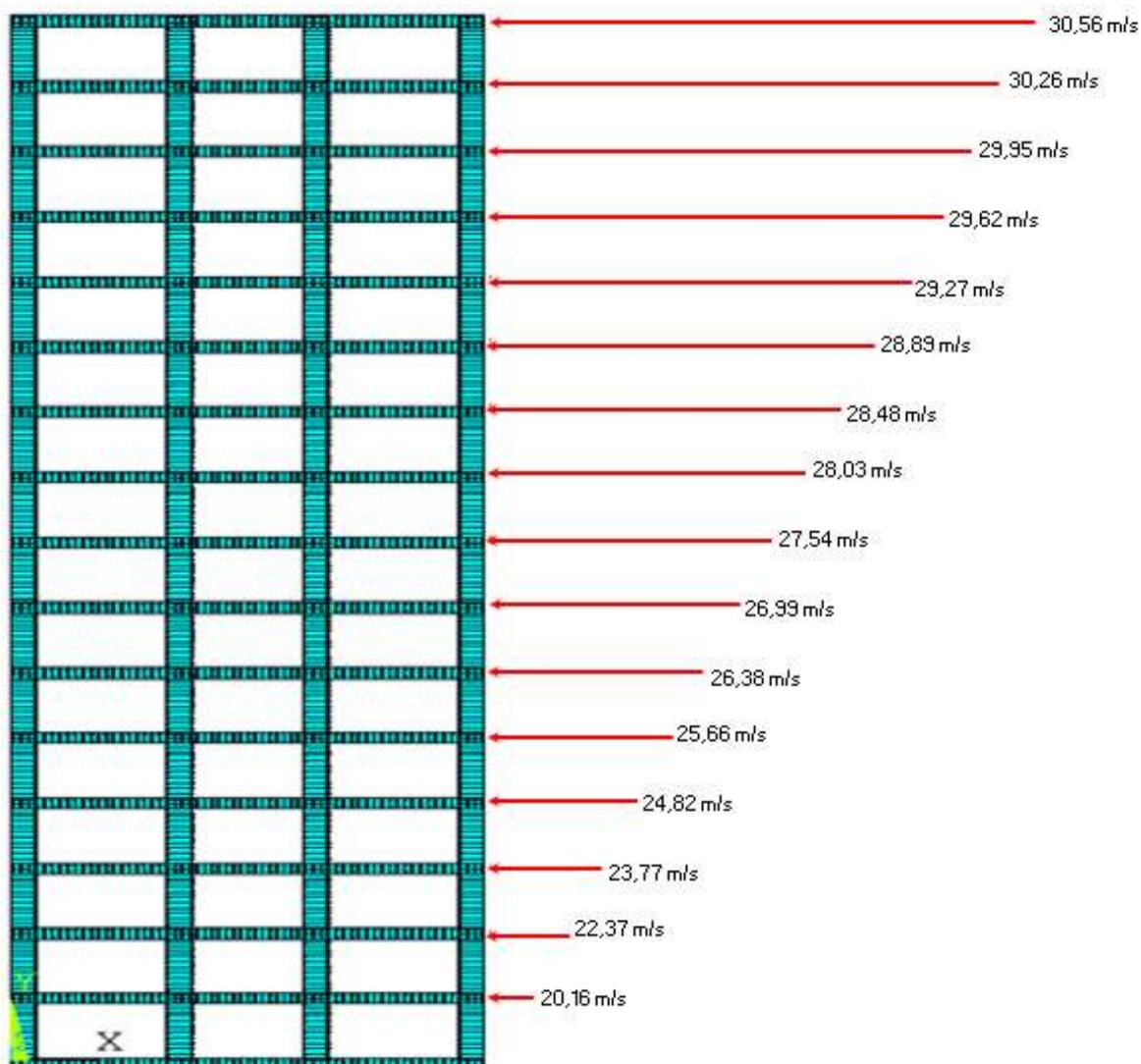
Figura 6 – Perfil da velocidade média do vento ao longo da altura
