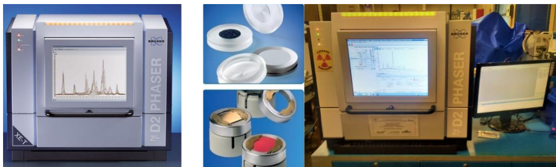
Figura 17: Sistema de XRD D2 Phaser (Bruker) e os porta amostras.
