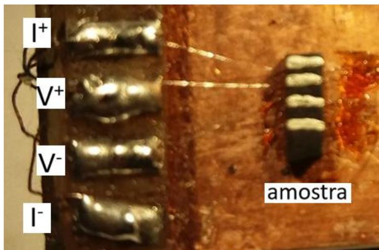
Legenda: Esquema experimental de contatos elétricos em uma amostra do sistema RE-123, utilizando fio de platina e tinta prata.
