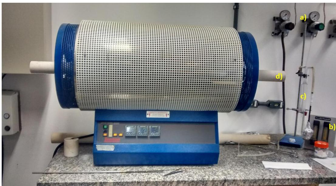
Legenda: Forno tubular da marca Lenton conectado a um sistema de fornecimento de oxigênio a um fluxo constante em: a) Regulador conectado ao cilindro de oxigênio; b) Controlador do fluxo de oxigênio que faz ajuste mais preciso do fluxo; c) Borbulhador que mostra o fluxo de oxigênio e d) Local onde se conecta a via de oxigênio ao tubo de quartzo dentro do forno tubular.
