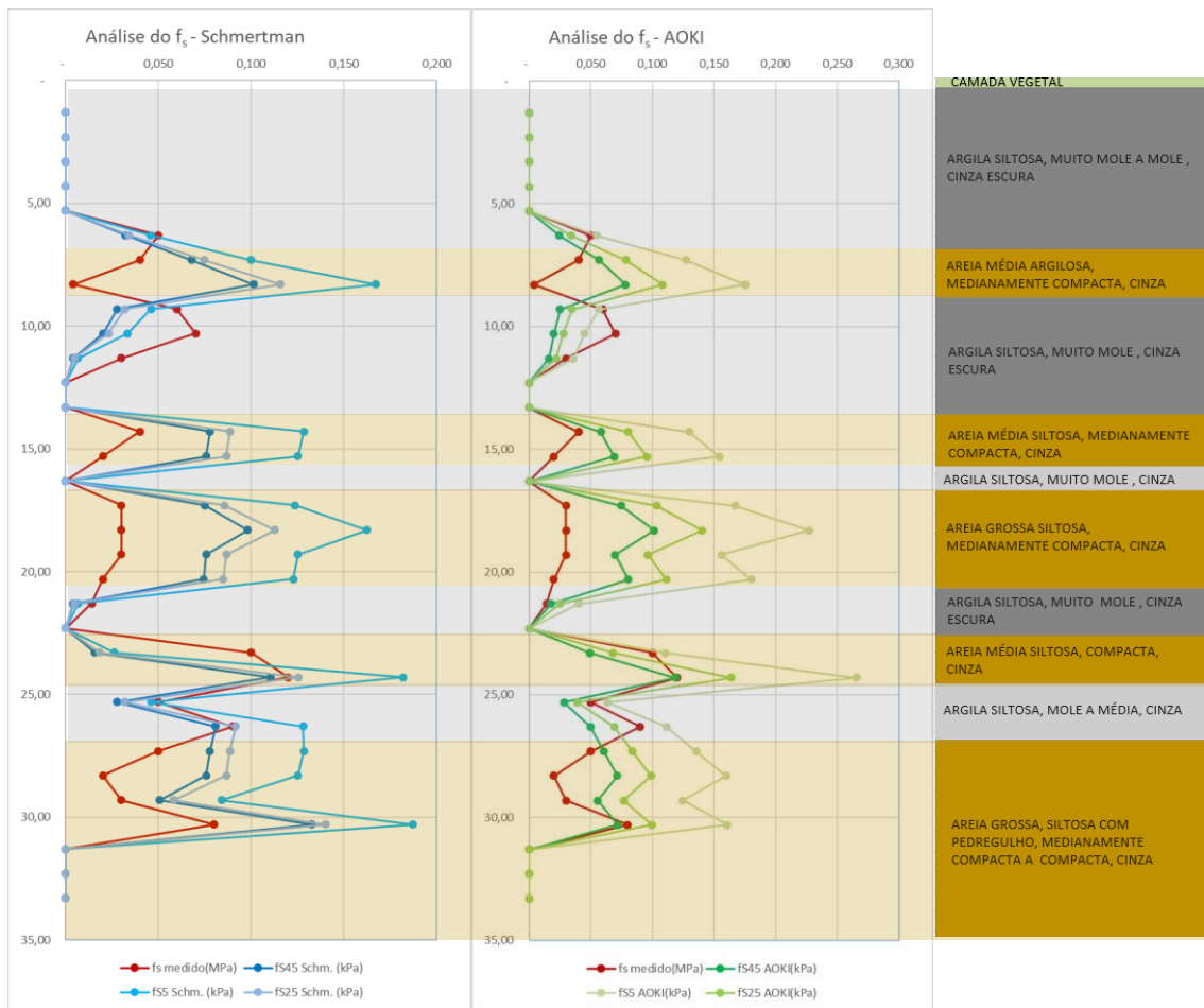
Figura B.68: Comparação das estimativas de resistência unitária de atrito lateral ( f_s ) para diferentes comprimentos de bucha pelo método de Schmertman (1979), em azul, e Aoki (2013), em verde, com os valores medidos por CPTU, em vermelho – SPT328 e CPTU328.
