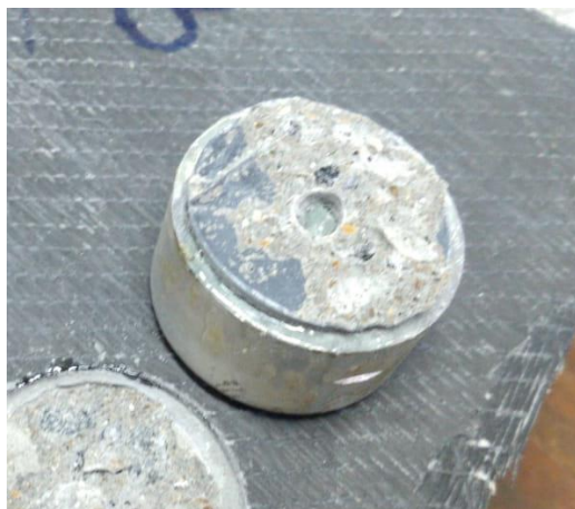
Figura 59 - Ilustração Tipo A/B - ruptura na interface substrato/revestimento.
