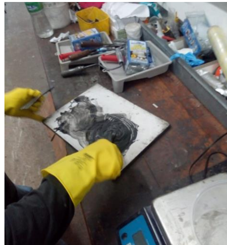
Figura 50 - Componentes A e B do adesivo estrutural epóxi Pipe Fix NVT 201E
