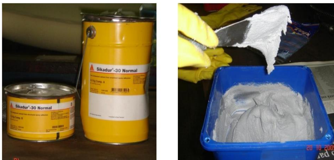
Figura 28 - Mistura da resina. (a) componentes A e B da resina; (b) consistência da resina após mistura
