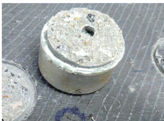
Figura 58 – Ilustração Tipo A – ruptura no substrato de concreto.
