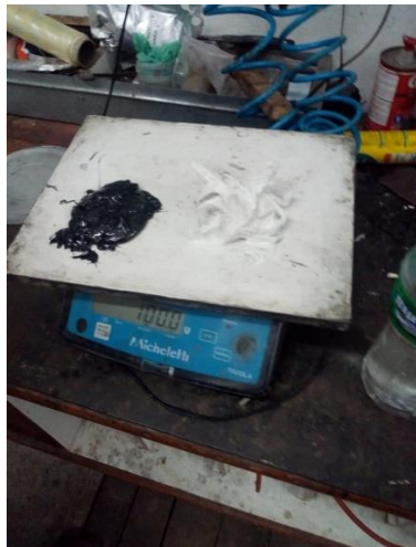
Figura 50 - Componentes A e B do adesivo estrutural epóxi Pipe Fix NVT 201E
