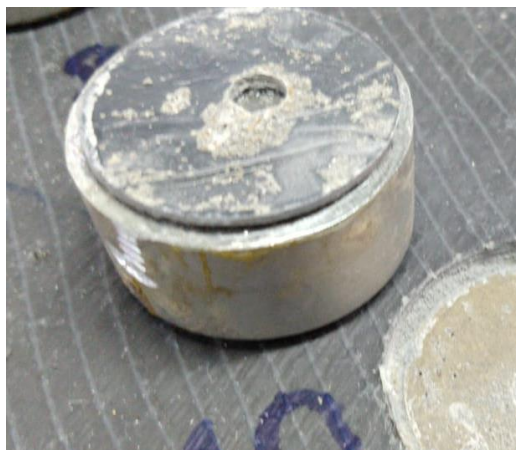
Figura 60 - Ilustração Tipo B - ruptura no revestimento.
