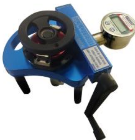
Figura 44 - Dispositivo de ensaio para o teste de aderência.
