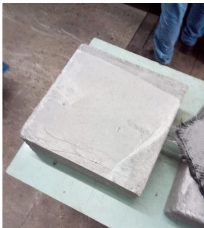
Figura 49 - Corpo de prova preparado para receber o reforço
