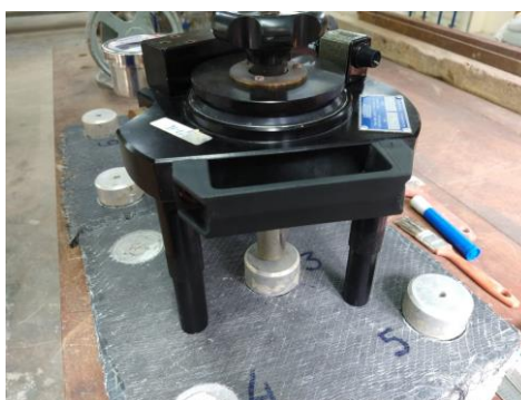
Figura 53 - Realização do ensaio de arrancamento
