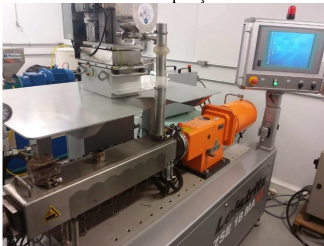
Figura 14 - Extrusora de rosca dupla utilizada para a preparação das diferentes composições e PP rec.
