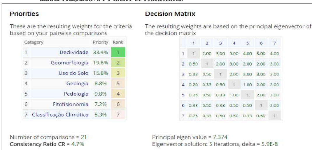
Figura 40 - Resultado do cruzamento das informações a partir software AHP Priority Calculator, evidenciando a matriz comparativa e o índice de consistência.
