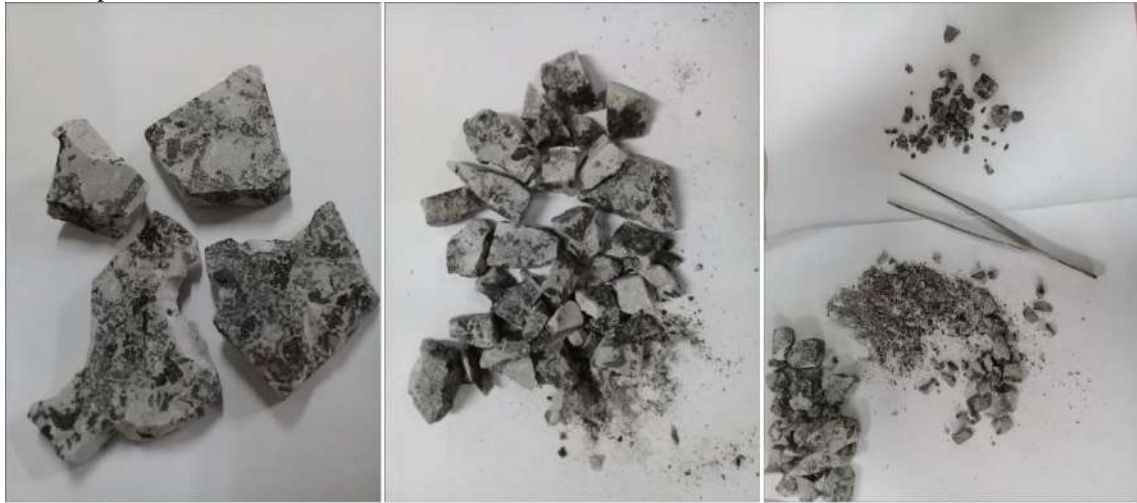
Figura 6 – Demonstração do quarteamento manual feito na amostra de pseudoleucita para, em seguida, ser pulverizada no moinho de bolas.
