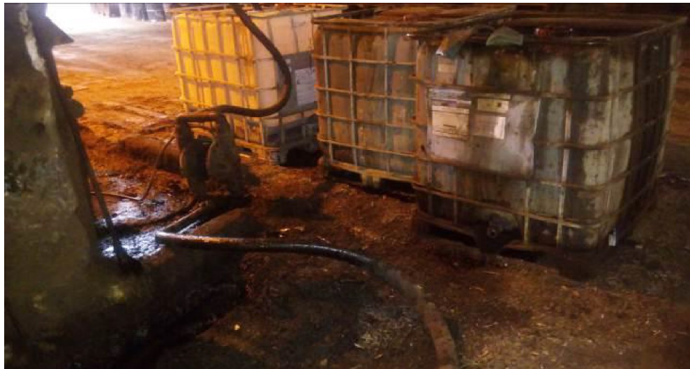
Figura 27: Bombeamento de resíduos líquidos para blendagem
