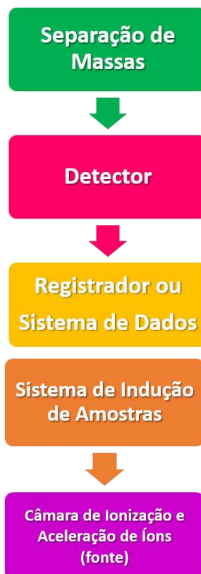
Figura 42 - Sequência de etapas do funcionamento de um espectrômetro de massa
