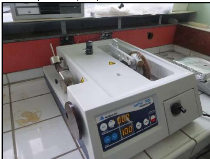
Figura 31 - Exemplo de máquina para feitura do corte do bloco de resina
