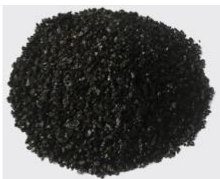
Figura 34 – Elementos filtrantes/adsorventes utilizados na coluna de adsorção para água da chuva.
