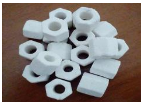
Figura 34 – Elementos filtrantes/adsorventes utilizados na coluna de adsorção para água da chuva.
