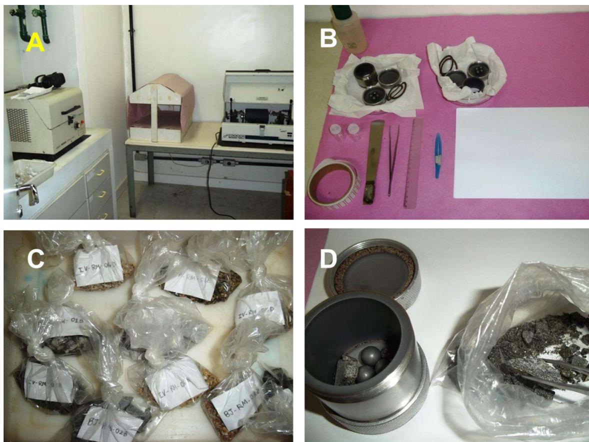
Legenda: Em (A), os moinhos; em (B), materiais utilizados para a pulverização das amostras, como os recipientes, as bolas de tungstênio e o material para o manuseio das amostras; em (C), as amostras britadas, embaladas e identificadas, em sacos plásticos; e em (D), o recipiente montado e pronto para o uso.
