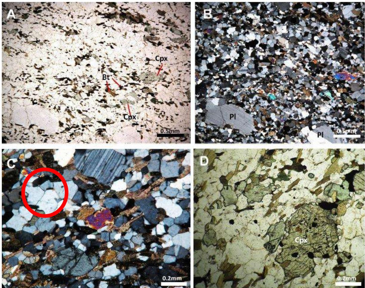
Legenda: A – textura levemente foliada marcada pela orientação de cristais de biotita lamelar; B – pórfiros de plagioclásio (Pl) com tamanhos que excedem 5mm; C – predominância dos contatos retilíneos (junções tríplices poliedrais) indicados no círculo em vermelho; D – textura poiquiloblástica (inclusões de minerais opacos em clinopiroxênio - Cpx). Luz plano polarizada em A e D. Luz polarizada em B e C.
