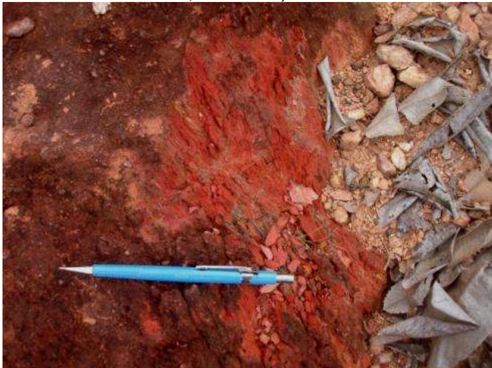
Figura 7 - Clorita xisto muito alterado, com a coloração avermelhada.
