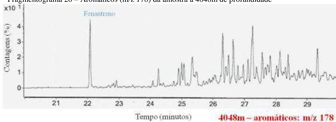
Fragmentograma 20 – Aromáticos (m/z 178) da amostra a 4048m de profundidade
