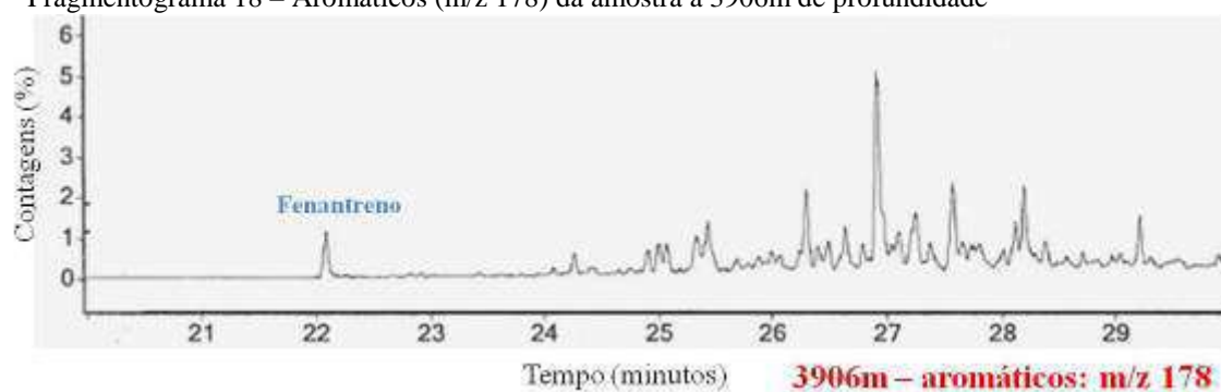
Fragmentograma 18 – Aromáticos (m/z 178) da amostra a 3906m de profundidade
