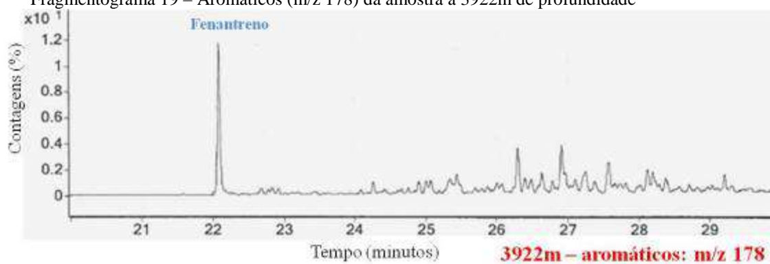
Fragmentograma 19 – Aromáticos (m/z 178) da amostra a 3922m de profundidade
