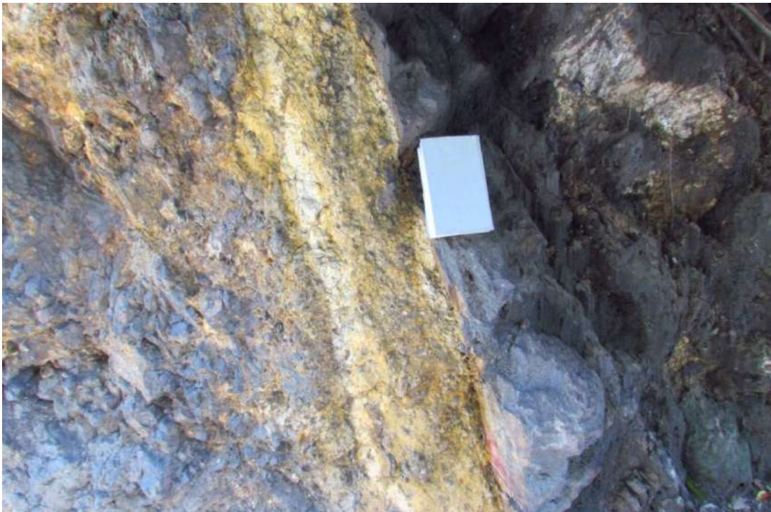
Figura 80 – Detalhe do gouge de falha (seta preta na Figura 79).
