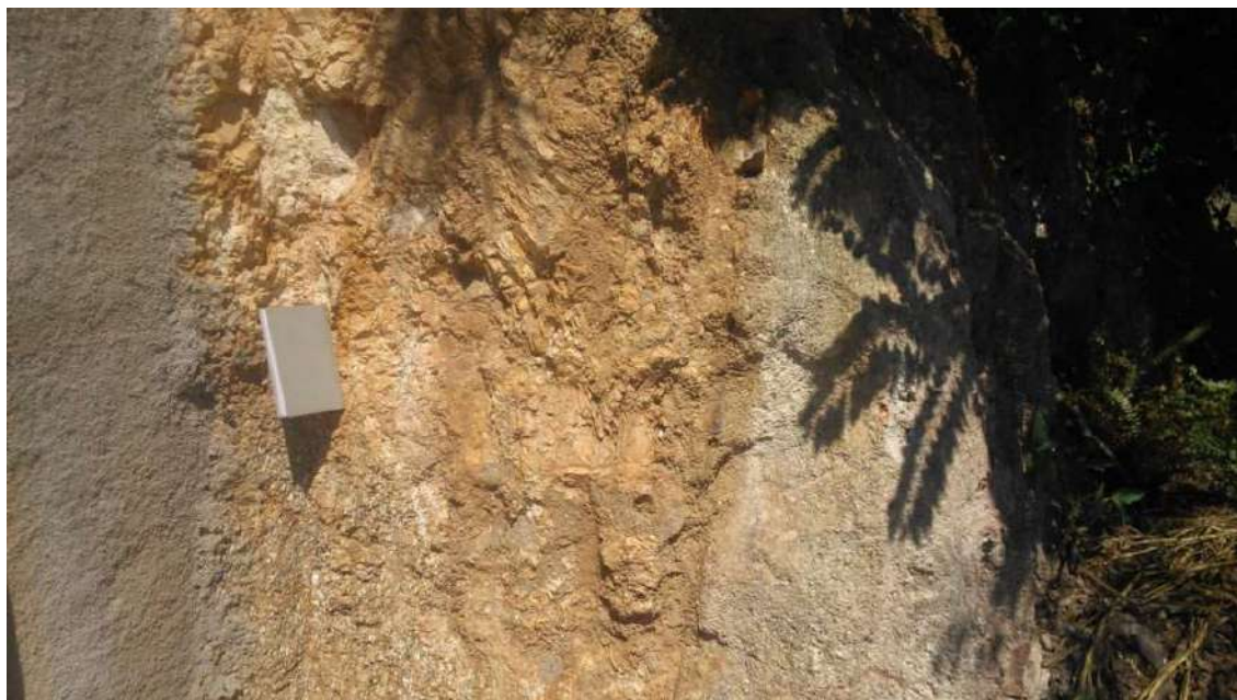
Figura 75 – Bolsões de caulinita e veios de calcedônia cortando o embasamento fraturado.
