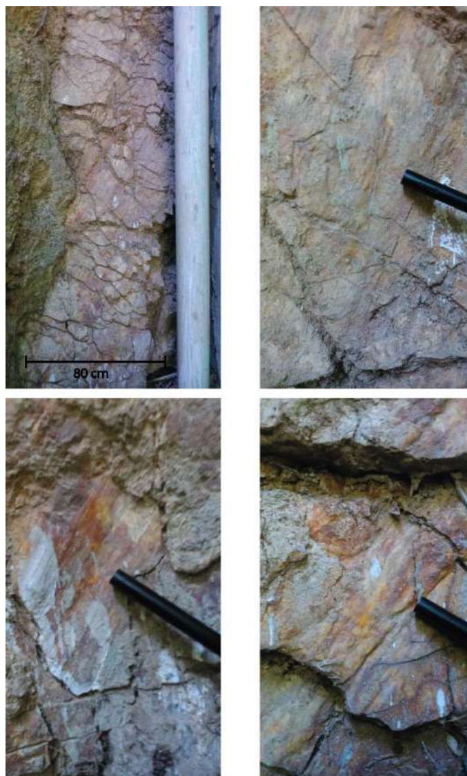
Figura 76 – Estrias sinistras reversas no plano da Falha de Itaipu
