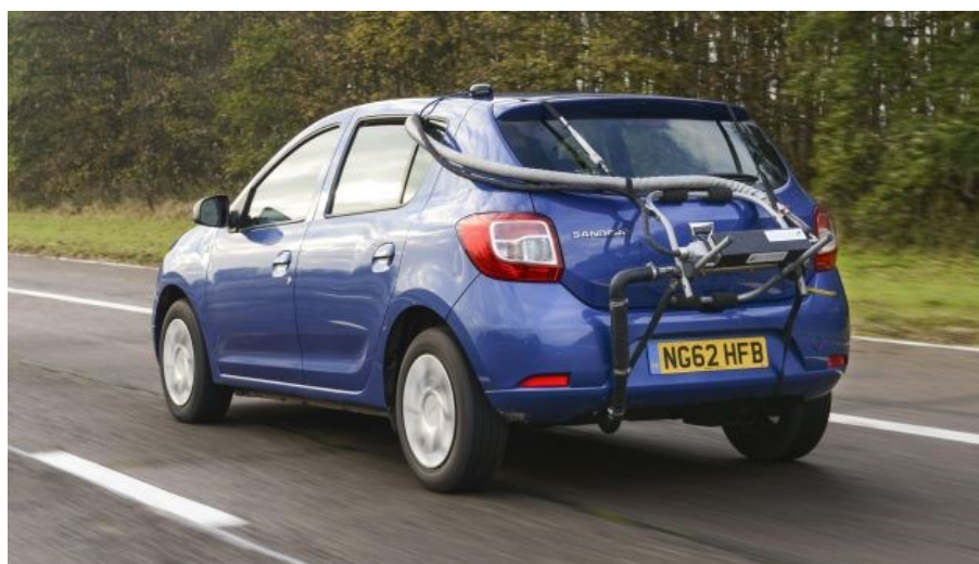
Figura 13 – Detalhe do ponto de coleta instalado no escape veicular
