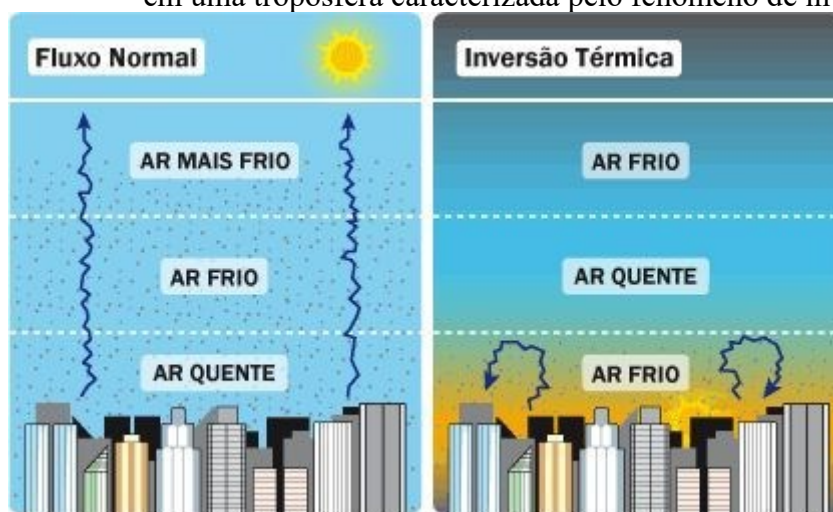
Figura 1 - Representação esquemática do fluxo de ar em troposfera normal e em uma troposfera caracterizada pelo fenômeno de inversão térmica
