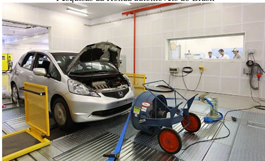
Figura 15 - Teste de dinamômetro de chassi realizado nas dependências do Centro de Pesquisas da Honda automóveis do Brasil
