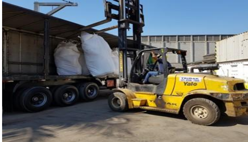
Figura 47 - Carregamento de perlita em “big bags” de 2 m 3 na carreta.
