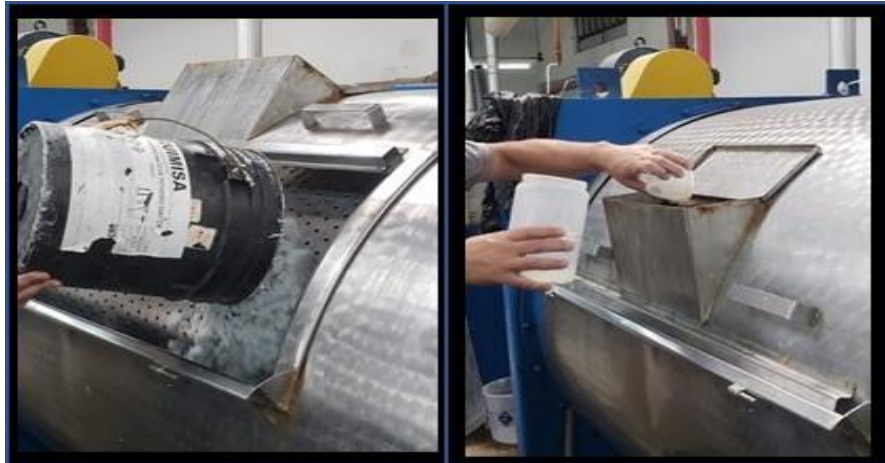
1. Adição de perlita na estonagem; 2. Adição de enzimas na estonagem.
