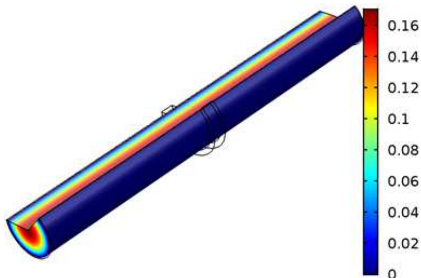
Figura 34 – Distribuição teórica de velocidade no fluido (m/s)
