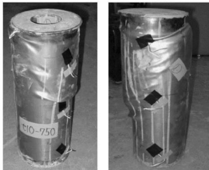
Figura 17 - Exemplos deformados, CFDST e CFT , respectivamente [17]
