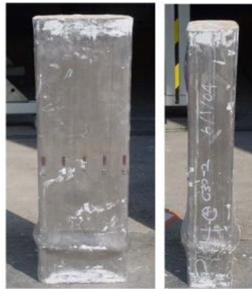
Figura 12 - Coluna mista preenchida com tubo em aço [26]
