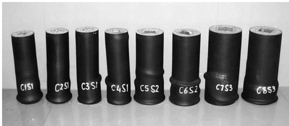
Figura 15 - Exemplares de CFST testado por Elchalakani et al [8]
