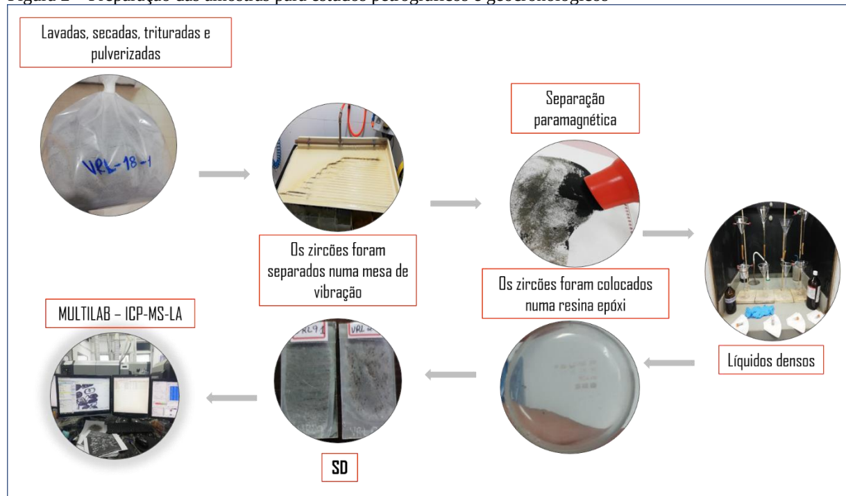
Figura 2 – Preparação das amostras para estudos petrográficos e geocronológicos
