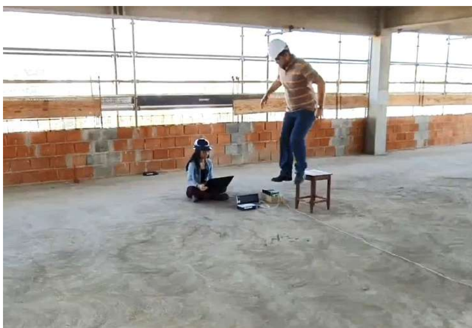
Figura 60 - Etapa 2 da realização do ensaio de vibração livre: salto.
