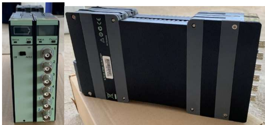
Figura 50 - Sistema de aquisição de dados Bruel e Kjaer.
