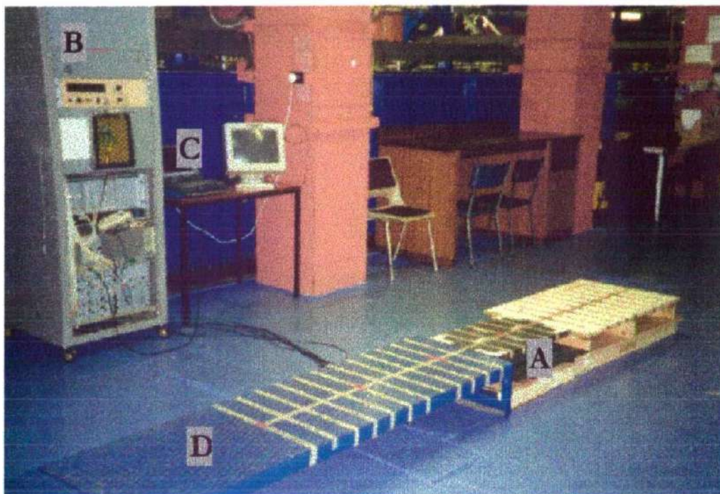
Figura 13 - Vista da plataforma de força (D), amplificadores (A) e sistema de aquisição de dados (B) / computador (C) [74].
