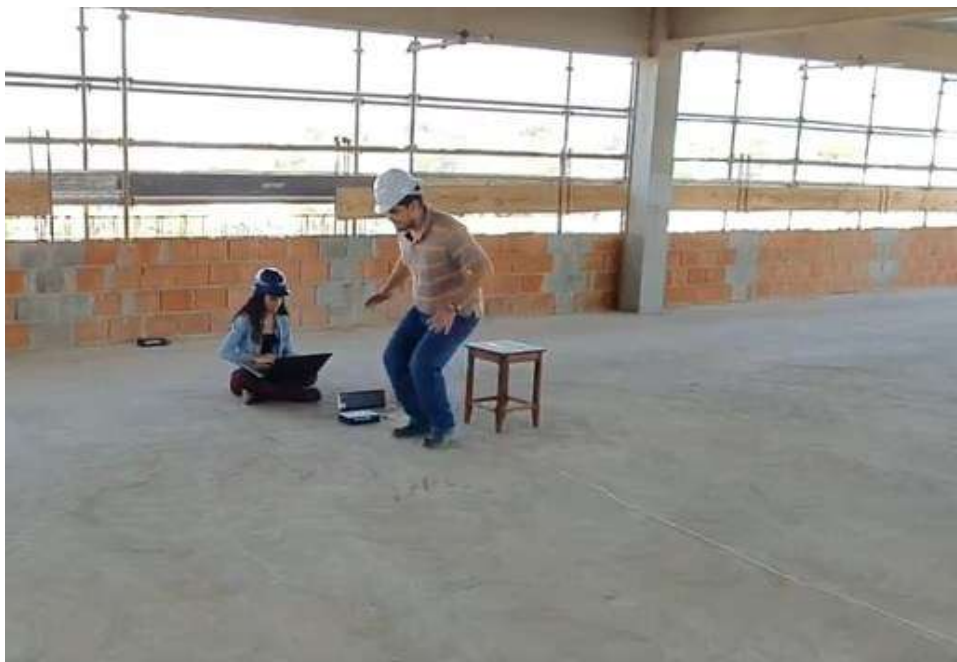
Figura 61 - Etapa 3 da realização do ensaio de vibração livre: impacto no piso.
