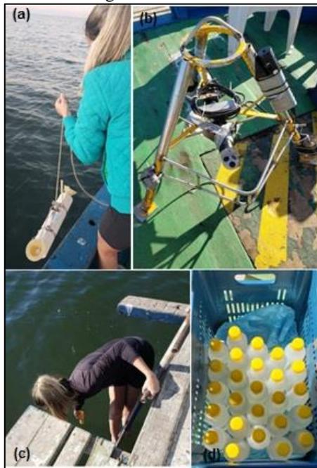
Legenda: (a) Garrafa Van Dorn; (b) Estrutura posicionada na Estação A; (c) Medida da profundidade com o auxílio do ecobatímetro de mão e (d) Amostras de água coletadas e armazenadas em recipientes de 500 mL.
