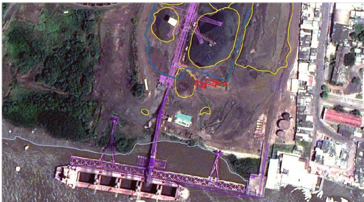
Figura 18 – Sobreposição de imagens sobre foto aérea de 16/09/2012, com pilhas de minério em amarelo, pátio de estocagem em azul e caixas de decantação em vermelho, indicativas do limite entre o solo resistente e o solo fraco (Pacheco, 2017)
