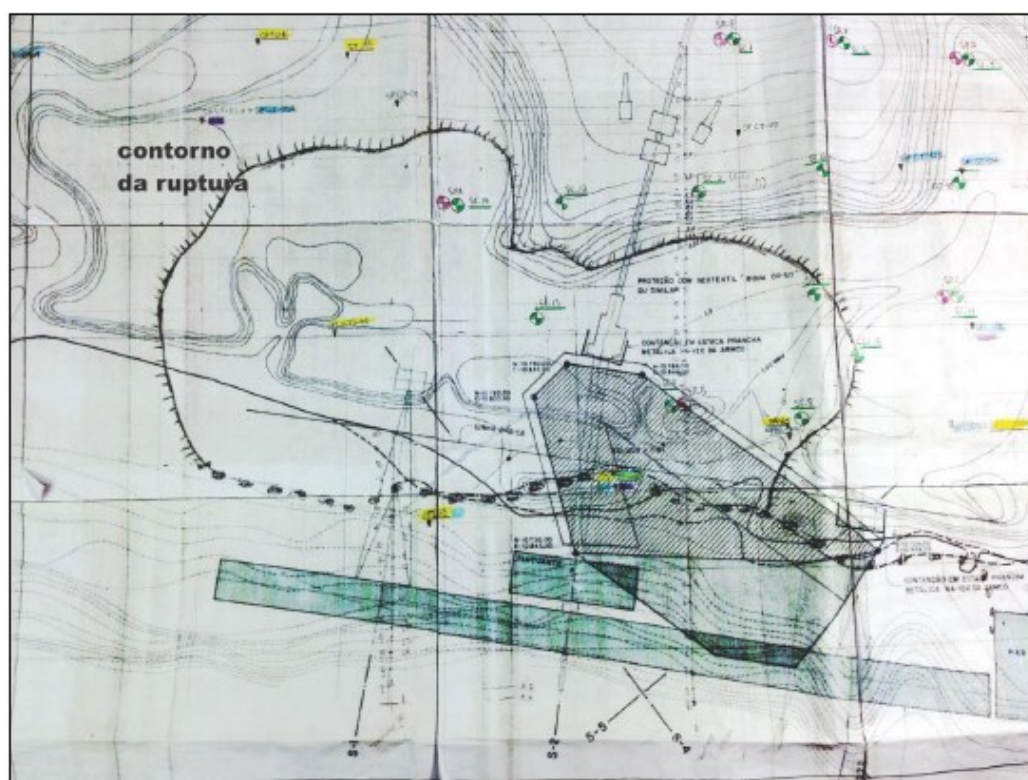
Figura 25 – Batimetria realizada em 2007, representativa da ruptura de 1993, com contorno da ruptura de 2013 e marcação dos pontos dos ensaios de 2007 e 2013 (Pacheco et al. , 2014)
