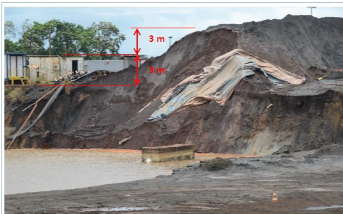
Figura 29 – Detalhe da pilha no trecho Leste, indicando que a ruptura ocorreu para uma altura de pilha de 6 m (Pacheco et al. , 2014)
