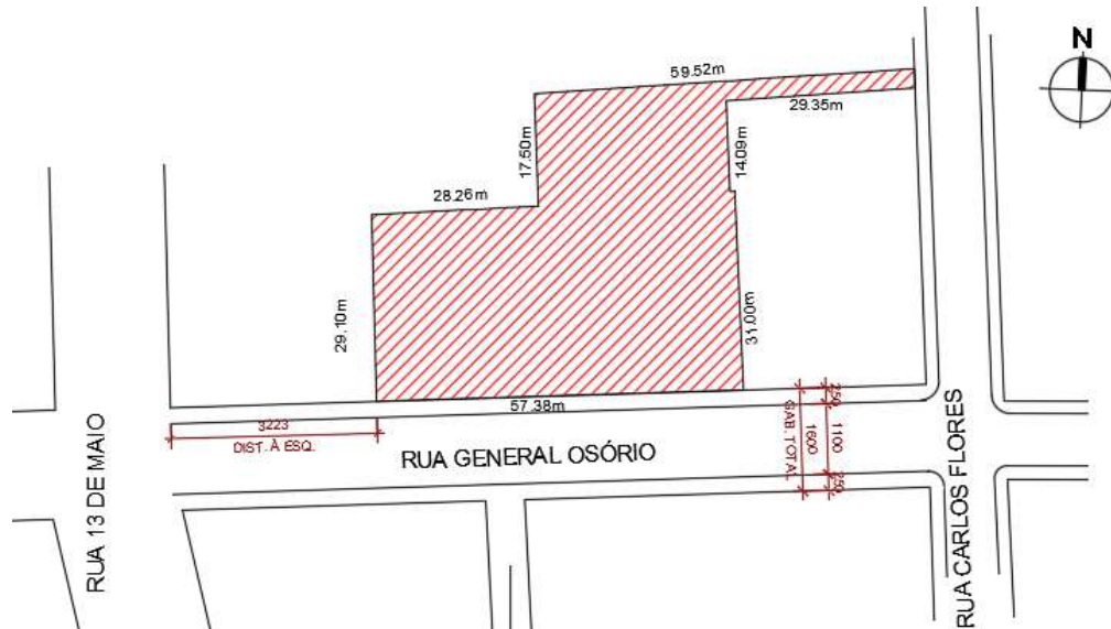
Figura 42: Planta de Situação.
