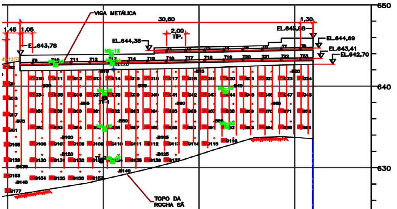
Figura 49: Detalhe da contenção na face leste.
