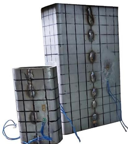
**Figura 25 – Perfis preparados para o ensaio.**
