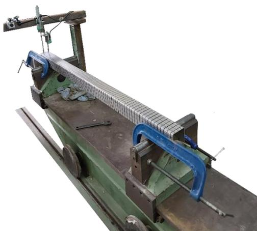
**Figura 15 – Configuração da verificação das imperfeições iniciais da alma do perfil C80X80X3X3.**
