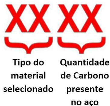
**Figura 1 – Classificação da AISI/SEA (Adaptado de [5]).**
