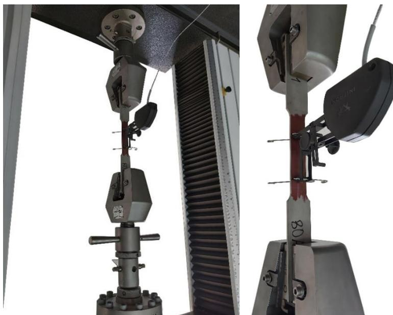
Figura 21 – Corpos de prova na máquina INSTRON 3382.
