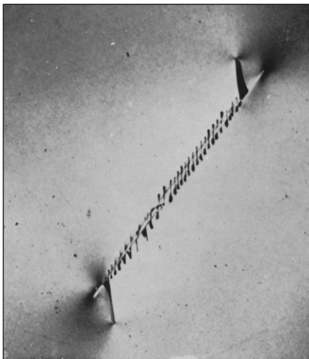
Figura 10 - Pequenas quebras entre as faces do fechamento da fissura em vidros Fonte: BIENIAWSKI (1967)
