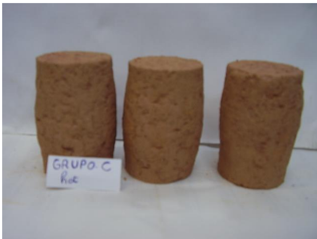
Figura 46 - Fotografia do ensaio triaxial – Grupo C Fonte: Arquivo pessoal Prof. Dr. Rogério Feijó
