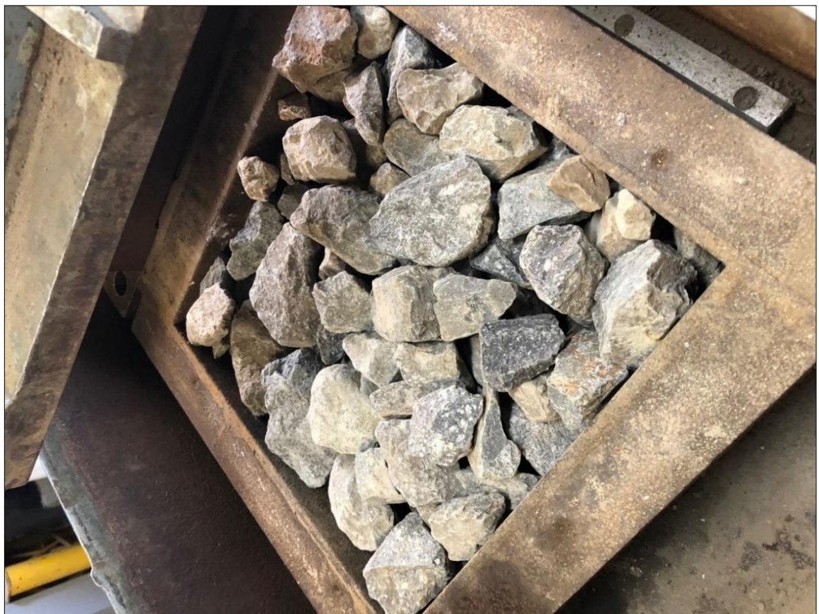
Figura 37 - Brita para lastro rodoviário Fonte: Arquivo pessoal Prof. a Ana Cristina Castro Fontenla Sieira
