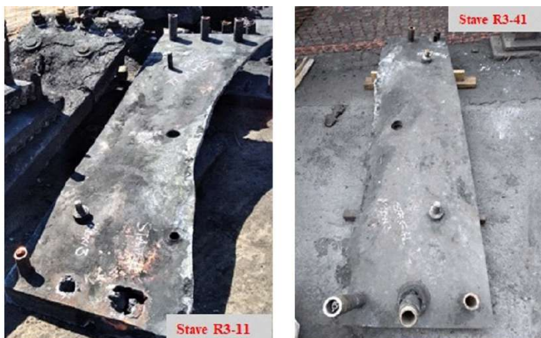
Figura 110 - Stave coolers de cobre retirados do alto-forno 2
